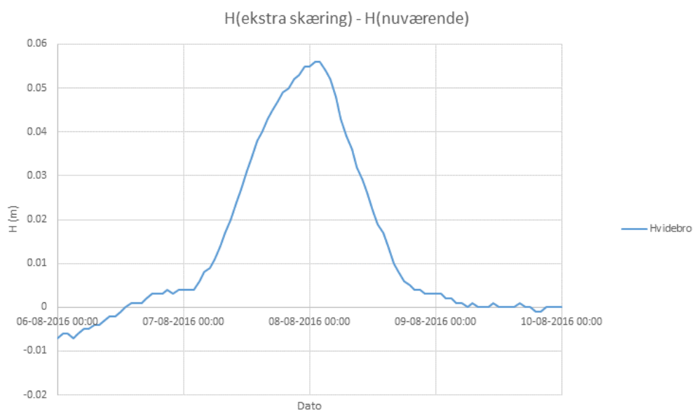
Figur 6.8: Kortvarig (ca. 1 døgn) forøgelse af vandstand ved Hvide Bro som følge af en ændret grødeskæringspraksis fra 3 bundskæringer og skæring af én brinksider til 3 bundskæringer og skæring af begge brinker.
