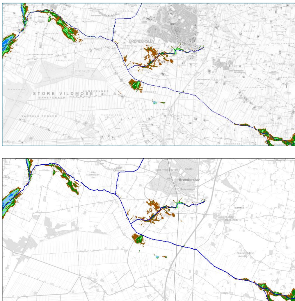
Figur 7.9: Oversigt over afvandingstilstanden omkring Ryå ved en vandstand i Ryå svarende til 75%-fraktilen af vandstande i perioden 10.10.2015 – 30.04.2016 ved nuværende forhold (øverst) og ved udvidelse af bundbredden (nederst).
